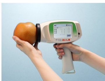
熟度の測定が可能な「CD-H240」。オプションで糖度の測定も可能に。
